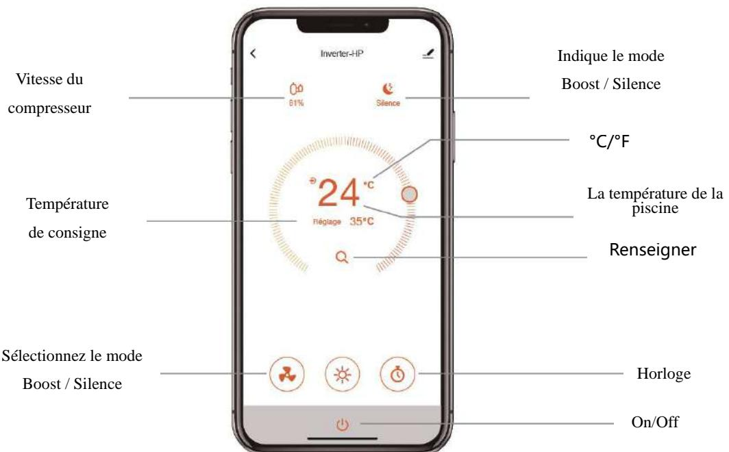
2. Pour les pompes à chaleur avec mode chauffage/refroidissement :
